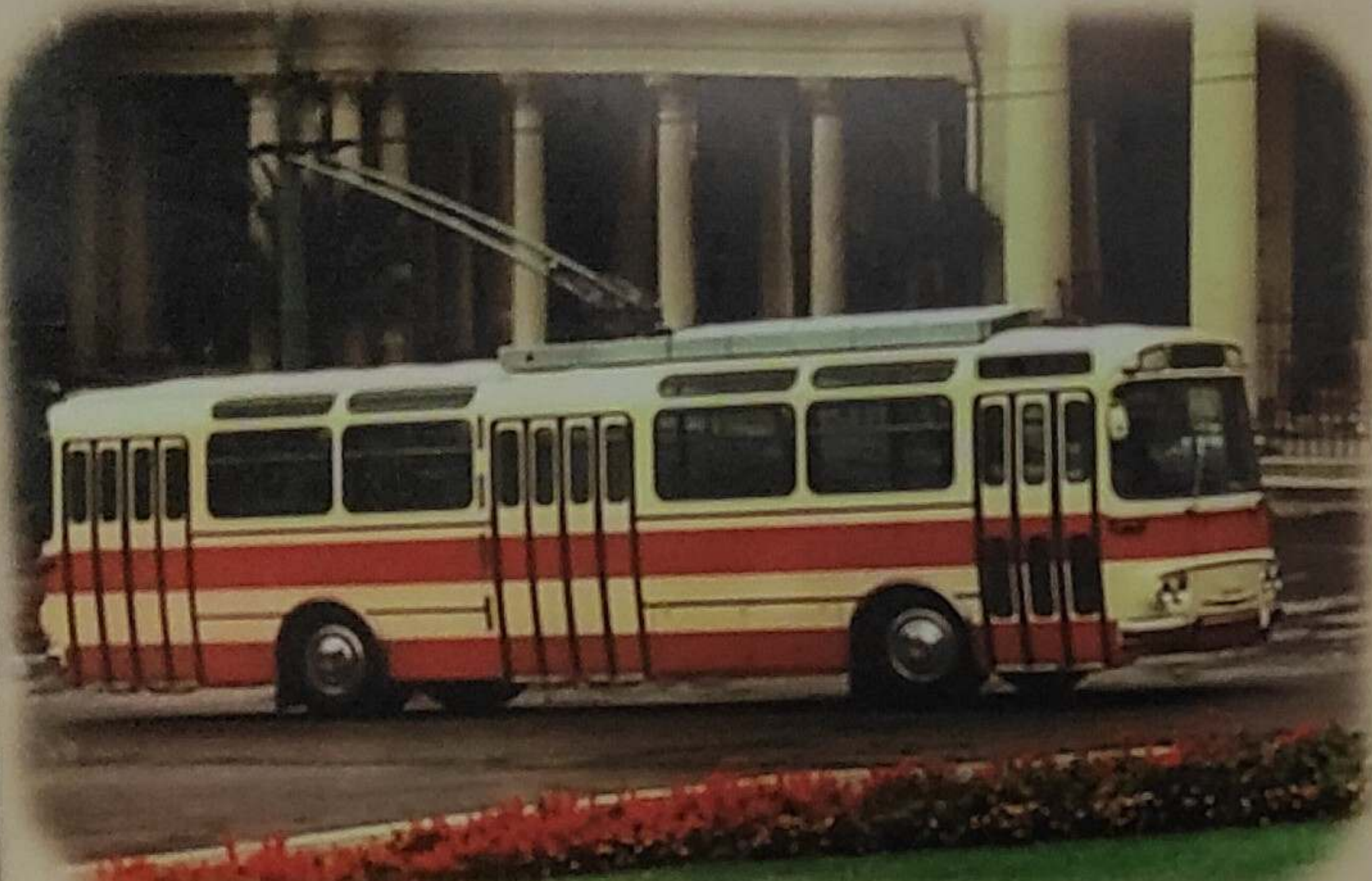
V počátcích provozu bylo možné jezdit kolem Kolonády i opačným směrem bez překládání sběračů díky výhybkám U hodin a na Mírovém náměstí. Na snímku prototyp trolejbusu T11 zkoušený zde v roce 1965.
